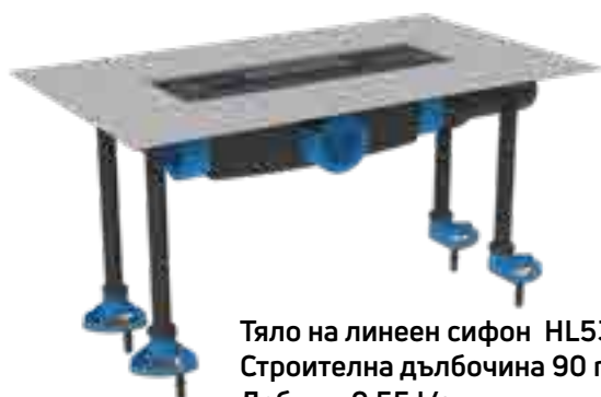
Тяло на линейен сифон HL53.0 Строителна дълбочина 90 mm Дебит = 0,83 l/s
